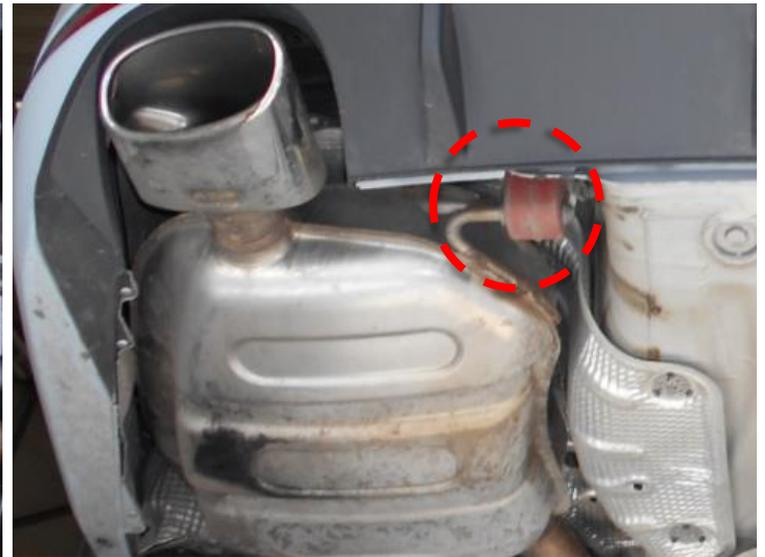
Den Aufhängungsgummi am Vorschalldämpfer montieren. Den REMUS Vorschalldämpfer auf das Serienrohr aufschieben und die Gummiaufhängungen an den Befestigungspunkten der Karosserie einhängen.
